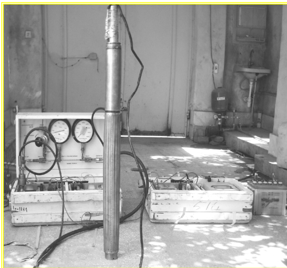
شکل ۳-۷- پرسیومتر خود حفار و تجهیزات مربوطه [۸۴]
